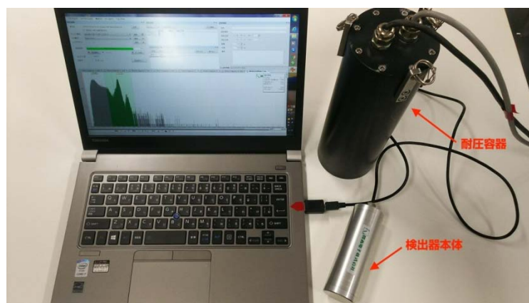
写真1 検出器本体、耐圧容器（黒色のアルミニウムケース）、PC
